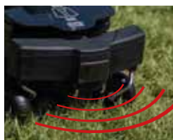
RADAR pour la détection d'obstacles
