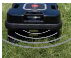
RADAR pour la détection d'obstacles
