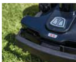
Pare-chocs et capteur d'obstacle souple
